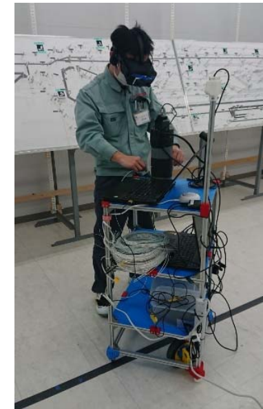
ワイヤーハーネス 作業支援システム (3DAR+深層学習+ 自律移動ロボット)
