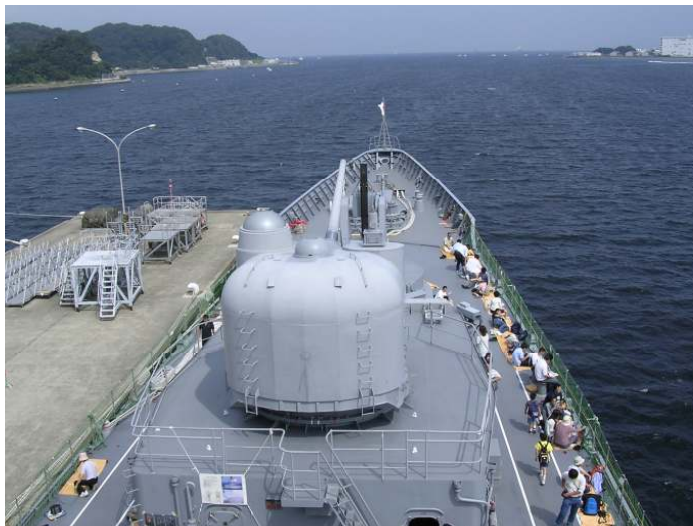
54口径5インチ短装連射砲 発射速度:35発/分 最大射程:23km
