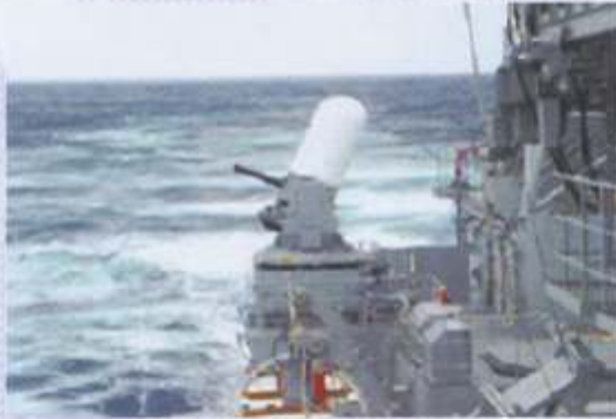
CIWS (Close In Weapon System) 近接する対空、対水上目標に 対処する自動機関砲です。
