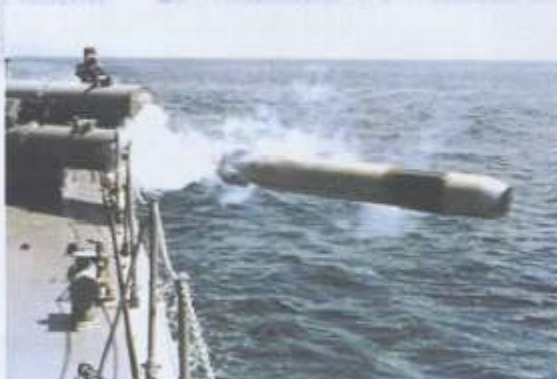
3連装短魚雷発射管 潜水艦攻撃用の魚雷を圧縮空気 で発射する装置です。
