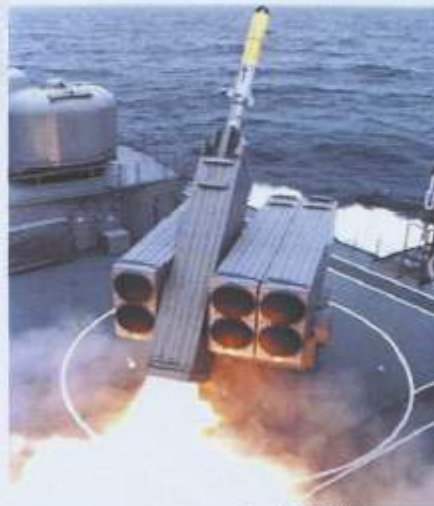
アスロック発射機 遠距離で探知した潜水艦に対し、 攻撃用魚雷にロケットを装着した アスロックを発射する装置です。
