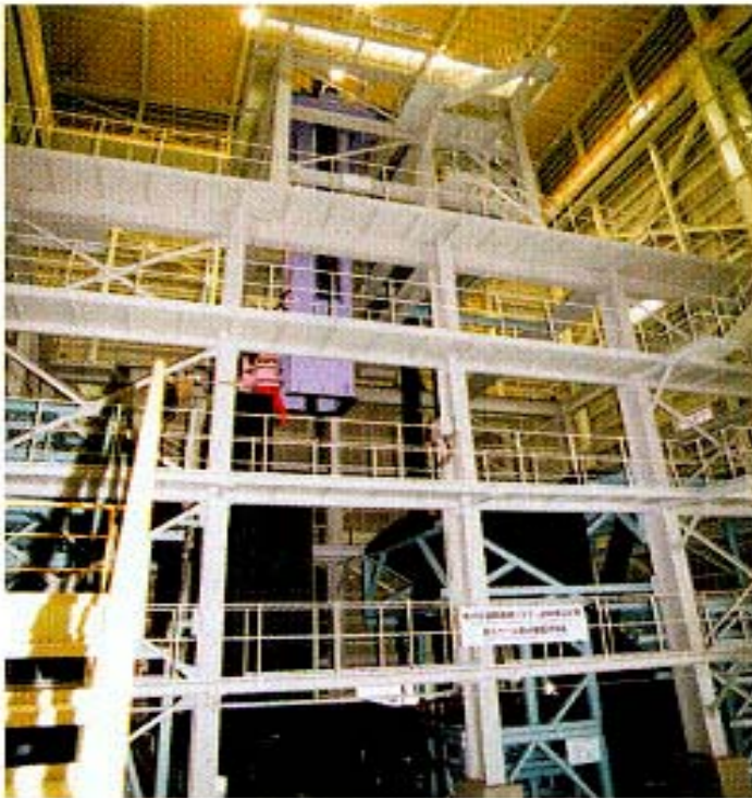
原子炉遠隔解体システム技術 （実スケール部分模擬試験体）
